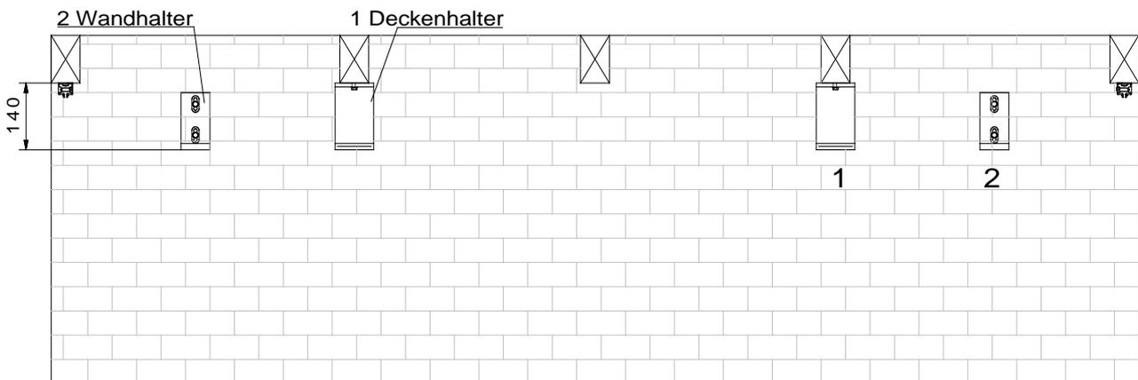
Zeichnen Sie die Bohrlöcher auf den Sparren bzw. auf der Wand an.
