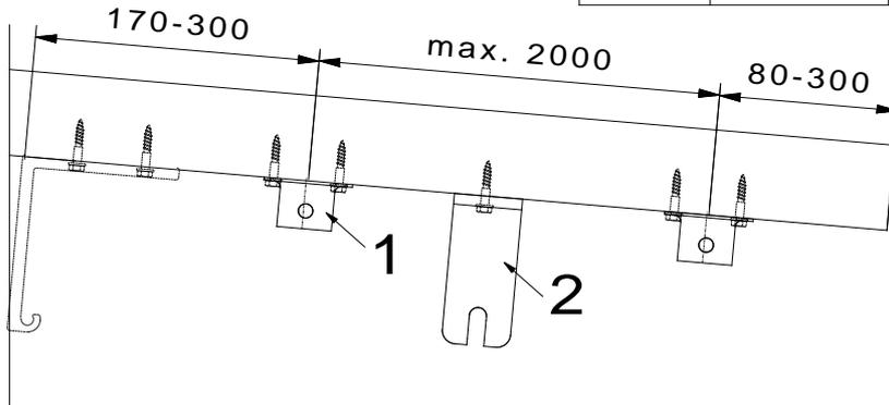
Bei Markisenfeldern mit Breite oder Ausfall über 400 cm kann es zu einem verstärkten Tuchdurchhang kommen. In Grenzfällen kann hier durch den Einsatz eines zusätzlichen Tuchstützdrahts entgegengewirkt werden.
